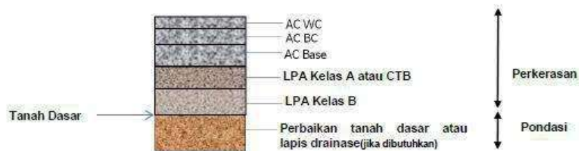
Gambar 2.3 Struktur Perkerasan Lentur pada Tanah Galian (Kementerian Pekerjaan Umum, 2017)
